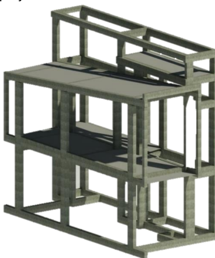
Figura 16. Vista tridimensional do projeto estrutural
