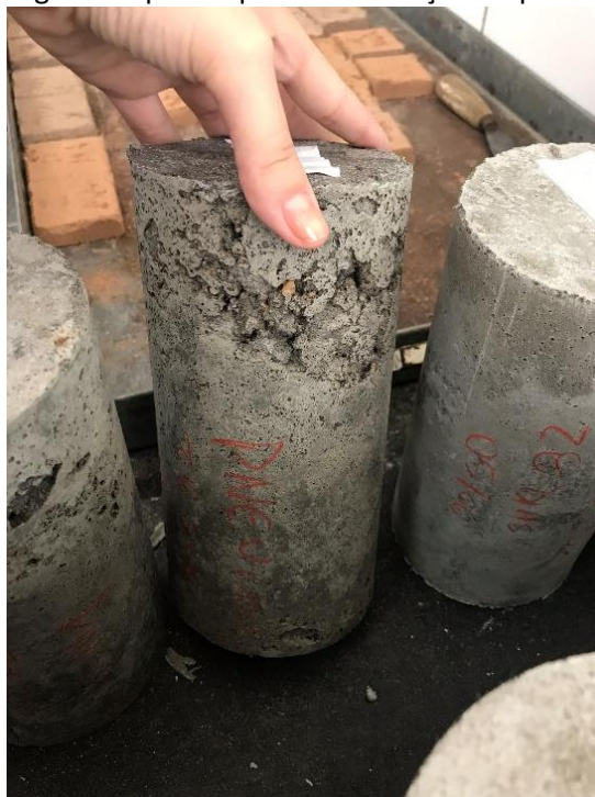
Figura 5. Bicheiras existentes em alguns corpos de prova com adição do pneu.
