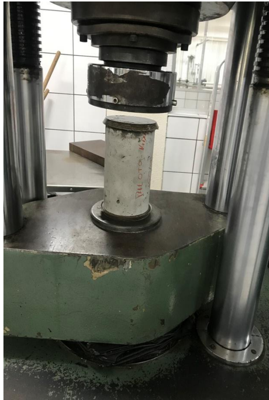
Figura 3. Copo de prova submetido ao ensaio de compressão.
