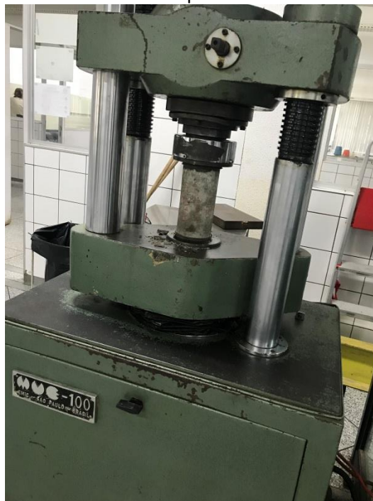
Figura 4. Copo de prova submetido ao ensaio de compressão.
