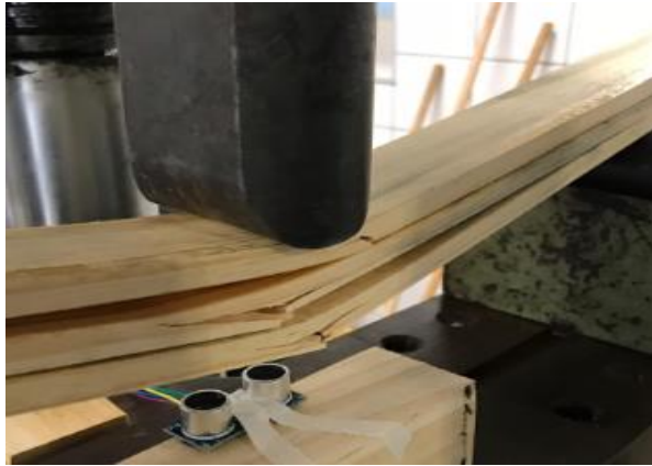
Figura 4. Corpo de prova (madeira laminada colada) durante ensaio com sensor ultrassônico sob ele
