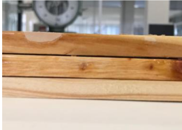
Figura 2. Corpo de prova com 3 lamelas já resinadas
