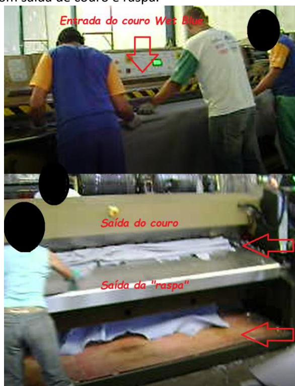
Figura 5. Máquina divisora com saída de couro e raspa.
