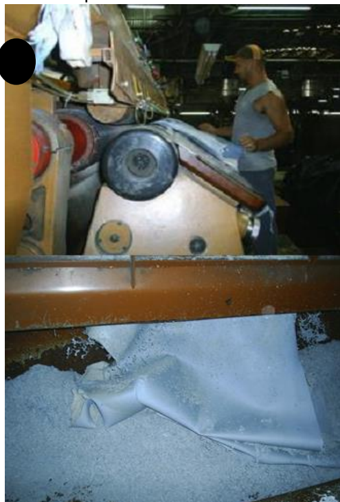
Figura 1. Máquina rebaixadeira e resíduo “pó de Wet Blue ”
