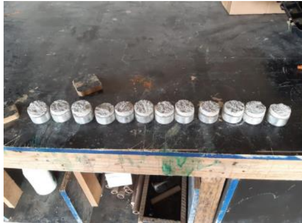
Figura 7. Corpos de prova após a ruptura
