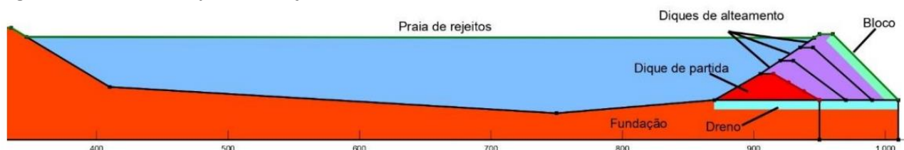
Figura 6. Alteamento à jusante lançado no software GeoStudio.
